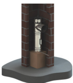
5.) Kondensatschale mit den vormontierten Formteilen auf den festen Schachtboden stellen
