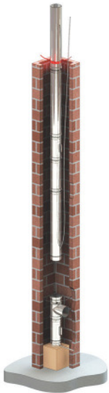
7.) Alle 3,0m muss eine Montageschelle am Rohr montiert und mit abgelassen werden.
