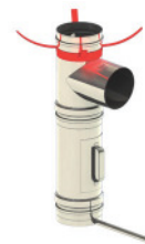
4.) Montageschelle am T-Anschluss befestigen
